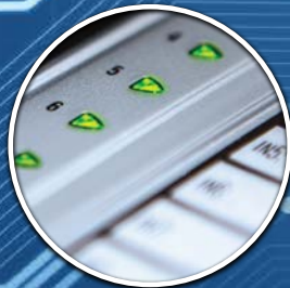
LEDs proporcionales proveen retroalimentación visual de las entradas y salidas
