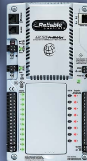
MACH-ProWebSys™ Combina un controlador BACnet de edificios (B-BC), una estación BACnet de operador (B-OVS) y un poderoso servidor web, en una misma unidad que ocupa la misma superficie de un controlador común de edificio.
