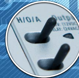
Interruptores HOA (Manual/Apagado/Auto) opcionales con retroalimentación de software que facilita los sobremandos
