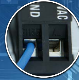
Bornes de jaula proveen una terminación superior del cableado
